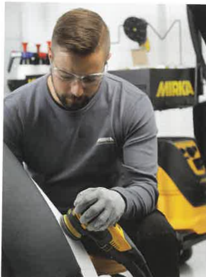
Die neuen Schleifgeräte verfügen über integrierte Vibrationssensoren und Bluetooth-Technologie, so dass über die MyMirka® App Vibrations-, Geschwindigkeits- und Nutzungsdaten abgerufen werden können.
